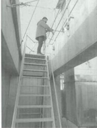
排气筒废气检测
