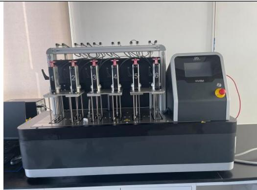
热变形温度试验仪
