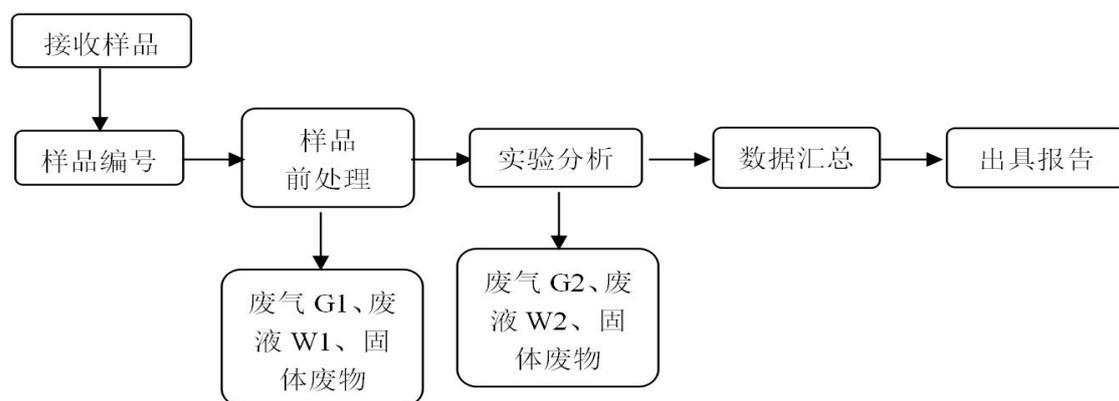
图 3-5 分析实验室工艺及产污环节节点图
